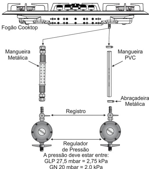
**Sugerimos fixar com abraçadeira, a mangueira de PVC flexível NBR 8613 ou a metálica NBR 14177 de alimentação, quando passar na área interna do móvel da cozinha. A tubulação não deverá passar dentro ou no vão de gavetas.**
