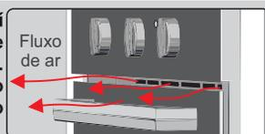
**Atenção:** Mesmo após o término do assado e do tempo programado, o sistema de resfriamento continua funcionando, o ar quente continua sendo soprado para fora do forno até que o produto se resfrie, desligando-se automaticamente;
