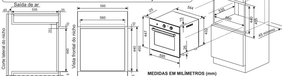
Para garantir o bom funcionamento do forno elétrico Fischer, é necessário que o nicho de embutimento tenha abertura para saída de ar quente.
