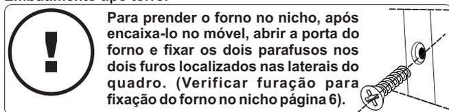
Para prender o forno no nicho, após encaixa-lo no móvel, abrir a porta do forno e fixar os dois parafusos nos dois furos localizados nas laterais do quadro. (Verificar furação para fixação do forno no nicho página 6).
